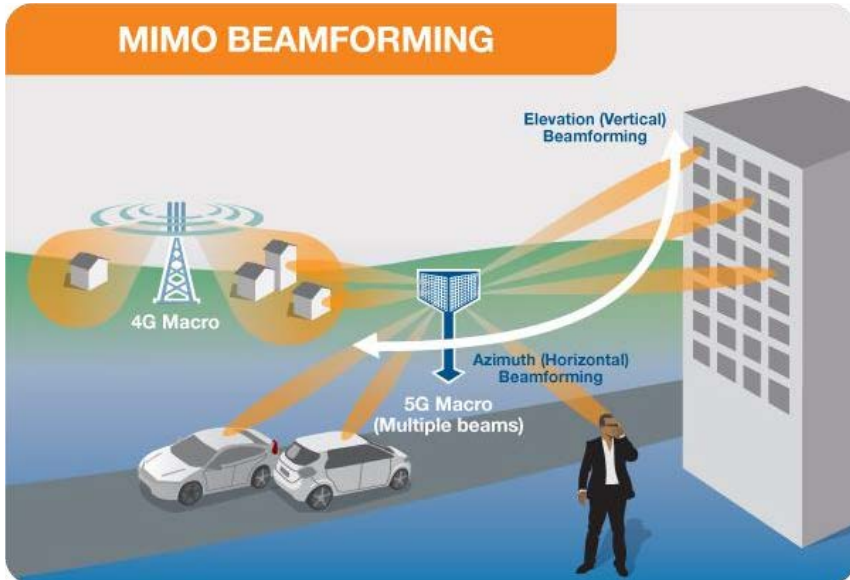
Rys. 1: Różnica pomiędzy wiązką dookólną generowaną przez sieć 4G oraz kierunkowymi wiązkami technologii 5G z zastosowaniem Beamformingu.
