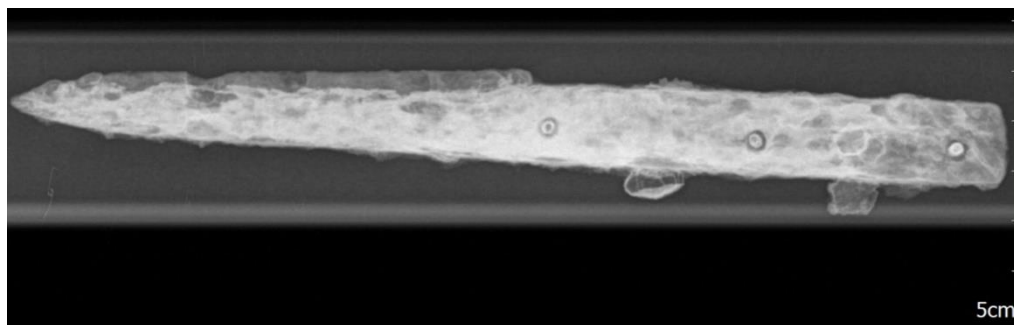
13. Nożyk z 3 nitami, samo ostrze praktycznie pozbawione rdzenia, u końca rękojeści po prawej stronie widoczny brak rdzenia.
